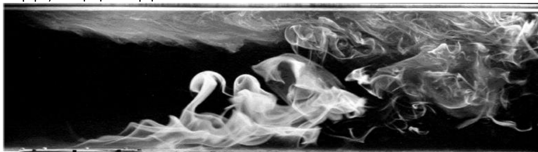
Εικόνα 1: Σχηματισμός καπνού σε σήραγγα από πυρκαγιά 15 KW
