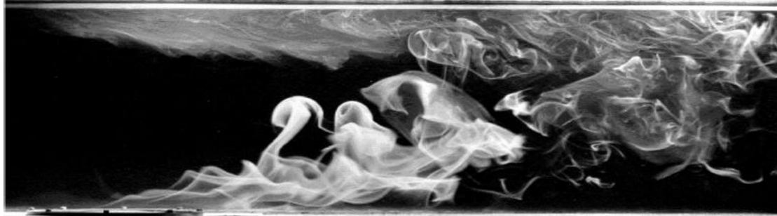
Εικόνα 1: Σχηματισμός καπνού σε σήραγγα από πυρκαγιά 15 KW
