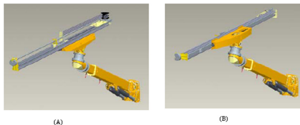
Εικόνα 2: Διάταξη στελεχών διάτρησης στην μπούμα
