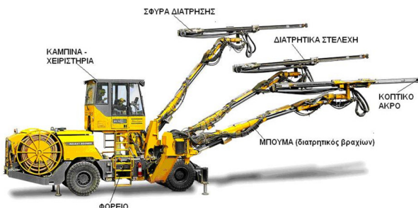
Εικόνα 1: Σύγχρονο τυπικό διατρητικό jumbo υπογείων
