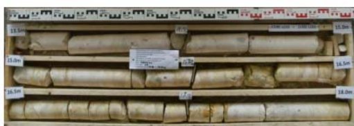
Σχήμα 3. Ασβεστόλιθος Simsima. (α) Αποσαθρωμένη και καρστικοποιημένη φάση (RQD<25%), (β) Υγιής φάση (RQD> 50%).
