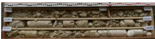
Σχήμα 2. Στρωσιγένεια του βραχώδους υποβάθρου. Διακρίνεται η καφέ χρώματος ιλυολιθική στρώση (Midra Shale) μεταξύ των ασβεστολιθικών στρώσεων (Simsima Limestone και Rus formation).
